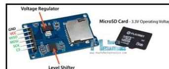
Gambar 2 Modul SD Card dan SD Card
