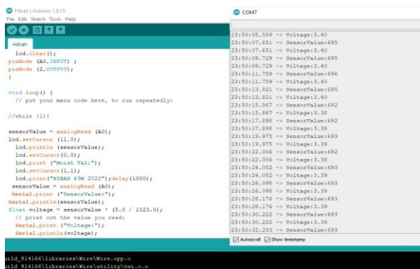
Gambar 7 serial monitor program untuk konversi data analog ke digital
