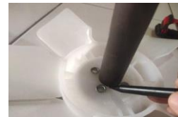
Gambar 6. Penyesuaian Ukuran Lubang Sudu Dengan Adaptor Sudu
